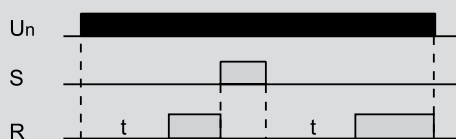
Диаграмма работы реле задержки включения ORT-A
