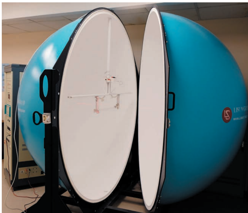
Фотометрические испытания продукции JAZZWAY
